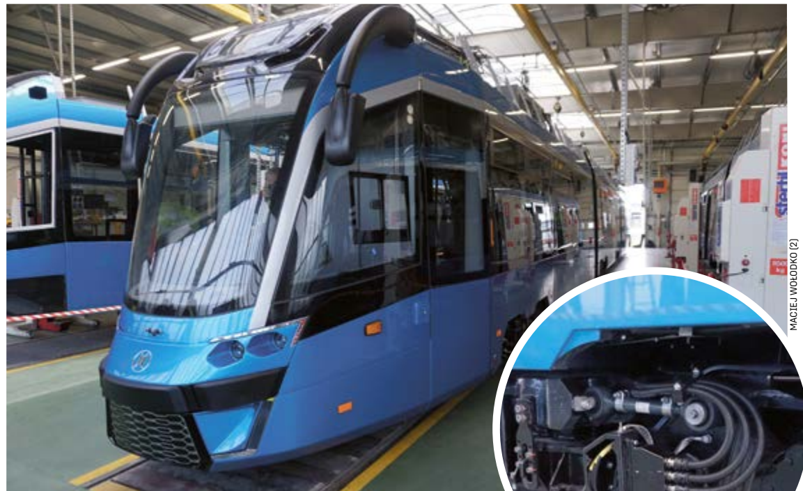
Moderus Gamma 2 ma nowoczesny (zbliżenie w kółku) układ napędowy, który pozwala na odzyskiwanie energii
